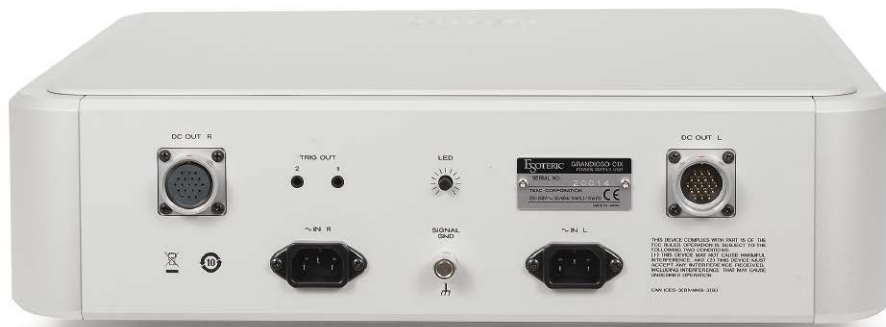
Zasilacz ma własną obudowę. Napięcie 230 V dostarczamy dwoma kablami, również para kabli prowadzi do właściwego przedwzmacniacza.
