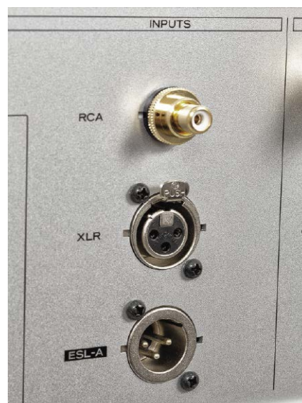
W zestawie wejść końcówki jest XLR/ESL-A, klasyczny XLR, a nawet niesymetryczne RCA.
